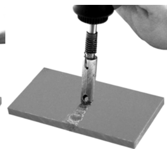
Das Einstechen und Glätten über die Länge des Risses wiederholen.
