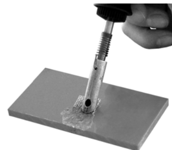
Die Matte muss unter die Oberfläche versenkt werden.
