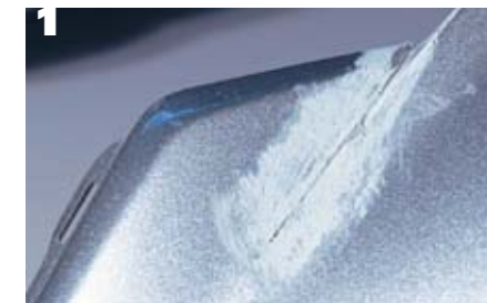
Um den Riss herum wird der Lack vollständig mit Schmirgel entfernt.
