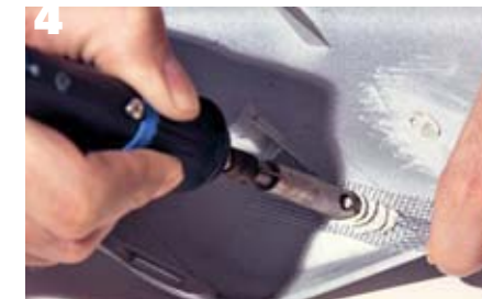
Die Armierung wird vom Riss beginnend vorsichtig ins Material eingeschmolzen.
