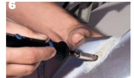
Nun wird der Riss von der Außenseite der Reparaturstelle mit dem Kolben verschmolzen.
