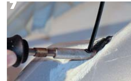
Fehlendes Material wird durch Schweißdraht ersetzt. Dabei ist die Zuführungsbohrung im Schweißkolben sehr hilfreich.
