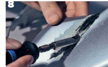
Die fertige Schweißstelle wird mit dem Kolben sauber »verputzt«. Bei guter Arbeit kann auf Nachspachteln verzichtet werden.
