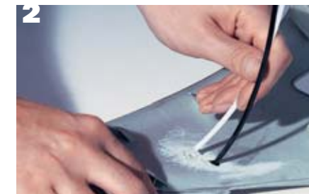
Zur Materialprobe werden verschiedene Drähte angeschweißt. Der, der gut haftet, ist richtig.
