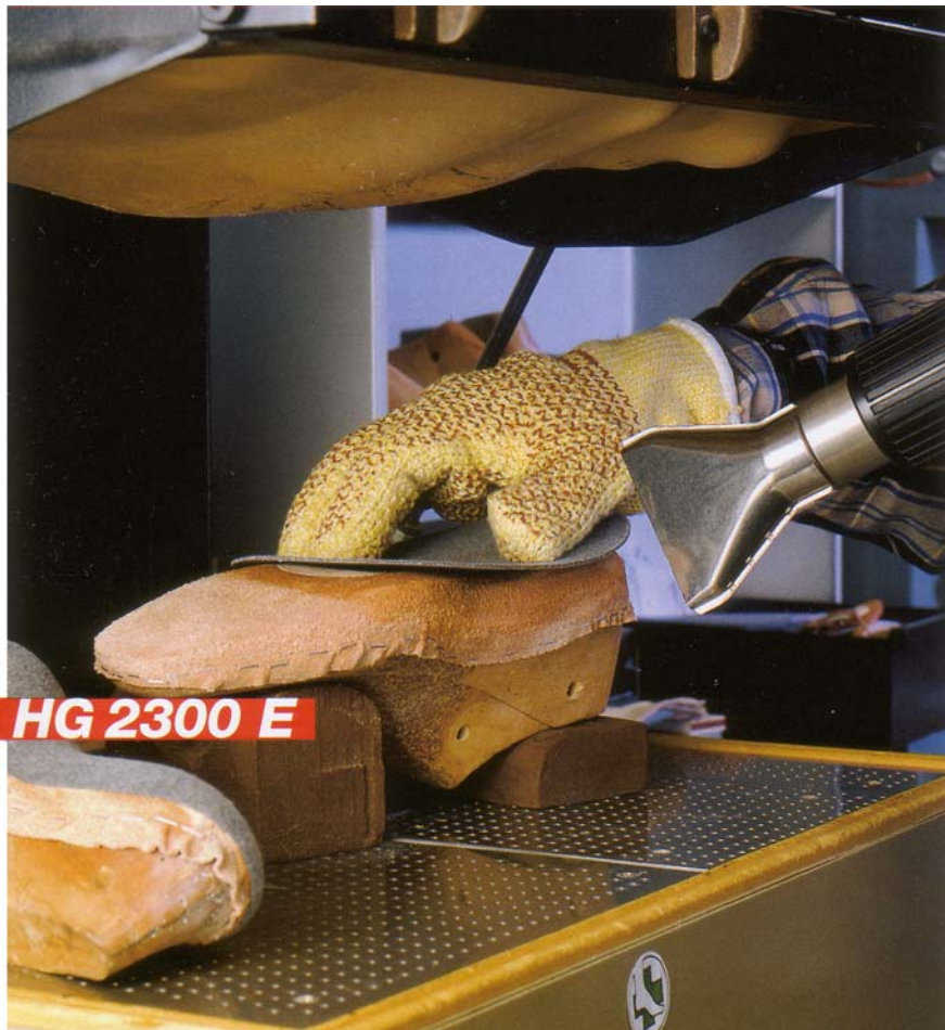
Verformen in der Orthopädie / Orthopaedic shaping
