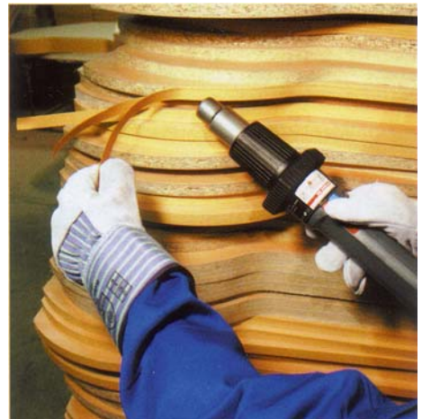
Kantenumleimer entfernen / Removing edgebands
